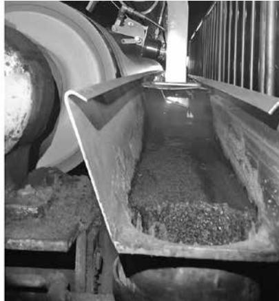
回収された洗浄水がセーブオール内を流れている
