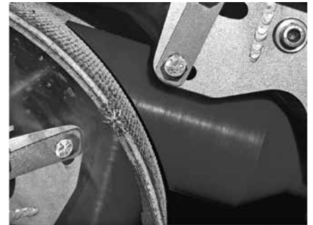
写真3 カンバスに近接した洗浄ヘッド
