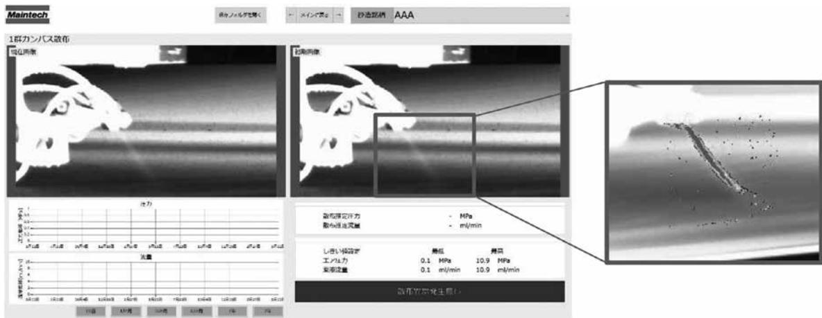
写真2 薬品散布ノズルのスプレー監視とRGB解析
