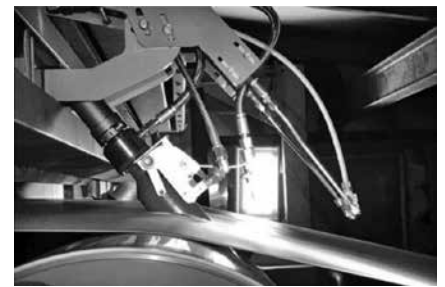
写真3 作業中のファブリキーパーヘッド
