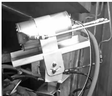
写真1 フード内撮影システム
