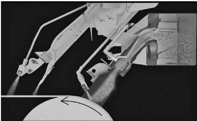
図5 汚れ・水の回収機構
