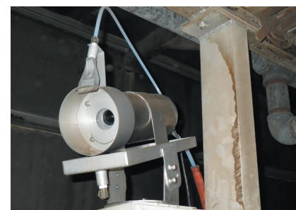
フード内上部のもっとも高温125℃にも耐える新設計。24時間撮影する。
