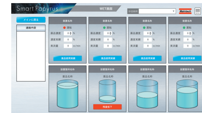
薬品の残量を自動管理、一定量を下回るとアラートメールが届く。
