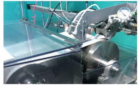
写真6 カンバス走行機とファブリキーパーテスト機
