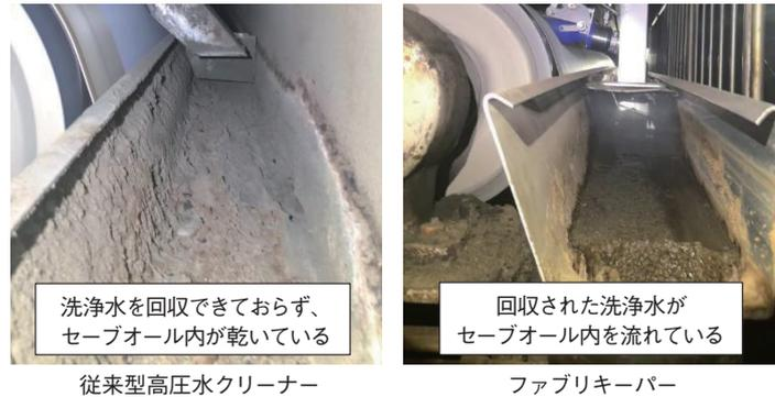
写真1 洗浄水の回収能力の比較
